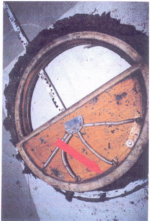
Detailaufnahme der lokal begrenzten Brandzehrungen von geringer Tiefe an der Ventilkappe und dem Holzring.
